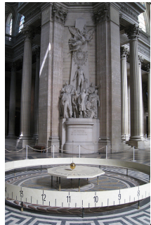
Physique Classique : Les déviations du pendule de Foucault montrent la rotation de la Terre
