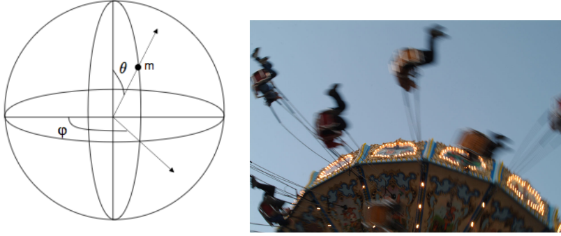
FIGURE 2. – Schéma d'un pendule sphérique et photographie d'un manège fonctionnant selon le principe du pendule sphérique.
