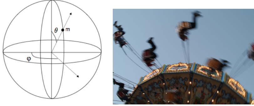
FIGURE 1. – Schéma d'un pendule sphérique et photographie d'un manège fonctionnant selon le principe du pendule sphérique.
